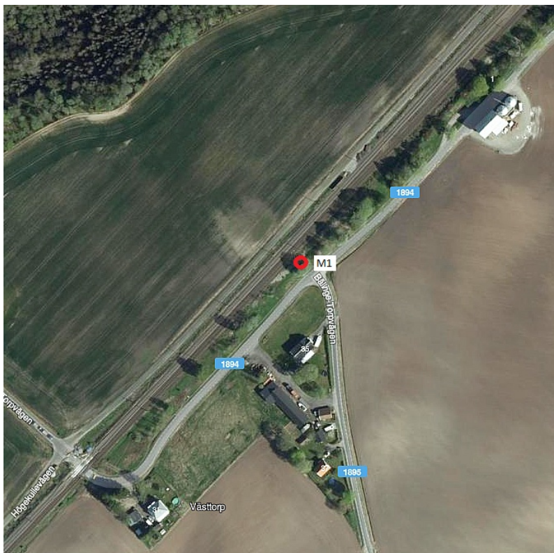
Foto 5: Dubbelspår vid Torp där ljudmätningar av tågpassager utförts på ca 225 m avstånd nordost om järnvägsövergången, mätpunkten 1 är markerad med en röd cirkel.
