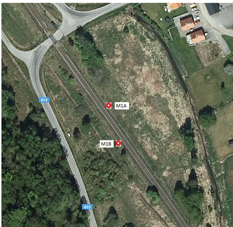
Foto 2: Enkelspår vid Skårby där ljudmätningar av tågpassager utförts söder om den bevakade vägövergången, de två mätpunkterna 1A och 1B är markerade med röda cirklar.
