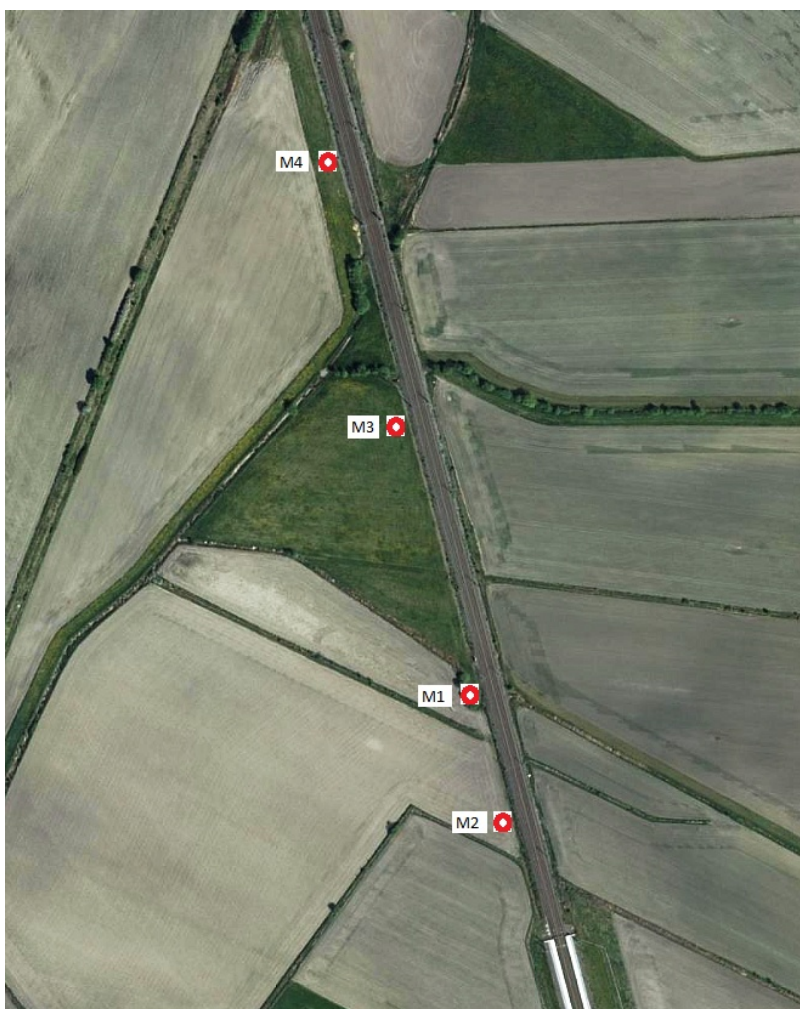
Foto 3: Dubbelspår vid Åsa där ljudmätningar av tågpassager utförts norr om hållplatsens perrong, mätpunkterna 1 – 4 är markerade med röda cirklar.
